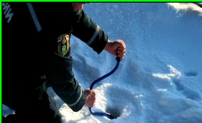
Ежедневно утром и вечером, а при оттепели и в дневное время, в районе переправы производится замер толщины льда и определяется прочность по его структуре.
